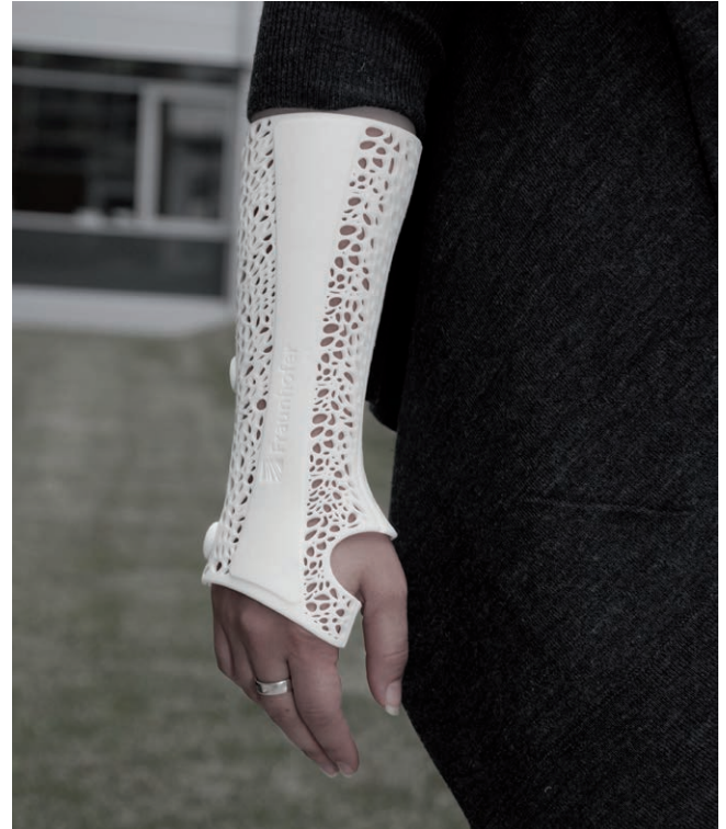
Abbildung 42 Individuell gefertigte Armschiene aus lasergesintertem Polyamid mit leichter, atmungsaktiver Zellenstruktur 88
